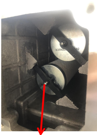
拆卸顶片将排气滤芯取出
