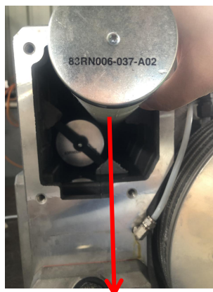
安装排气滤芯（注意密封线朝下安装）
